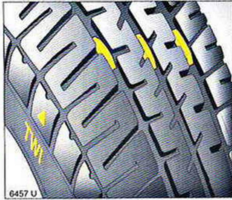
Минимальная допустимая по закону высота рисунка протектора (1,6 мм) достигается, когда протектор изнашивается до указателей износа (TWI<sup>1)</sup>). Несколько указателей износа нанесены на одинаковом расстоянии друг от друга в протекторе ходовой поверхности. Их положение отмечено также указателями на боковой поверхности шины.
