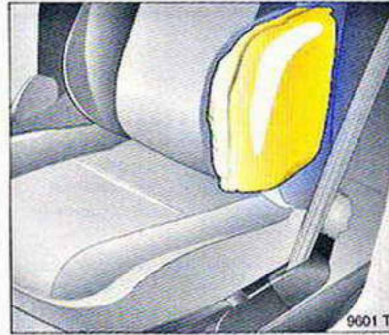
При срабатывании боковая подушка безопасности с течение миллисекунд наполняется газом и образует предохранительный амортизатор для водителя и переднего пассажира в зоне соответствующей передней двери. Таким образом при боковом столкновении существенно уменьшается опасность травмирования верхней части тела.
