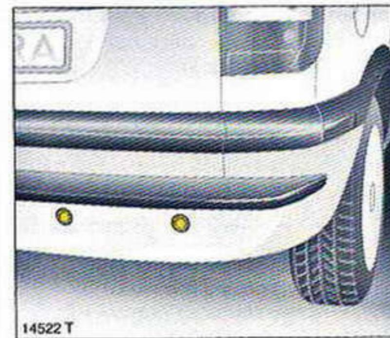
Устройство регистрирует расстояние до препятствия посредством четырех датчиков, расположенных в заднем буфере. Чтобы избежать функциональных сбоев или неправильной информации, датчики должны не иметь повреждений и быть свободны от грязи, снега и льда.
