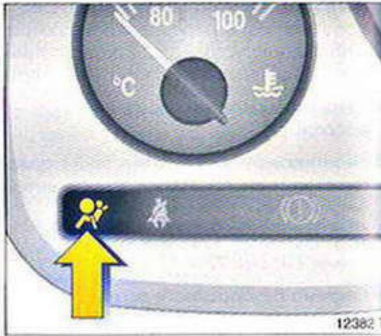
Сигнализатор систем воздушных подушек безопасности
