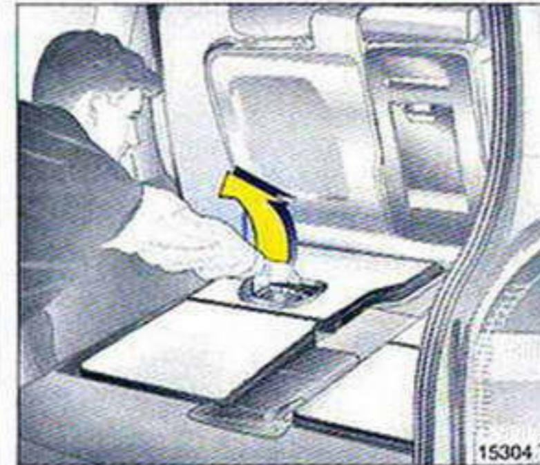
Со стороны багажника потянуть сидение одной рукой за ручку вверх, отклонить назад и установить вертикально, зафиксировав до ощущимого щелчка. При этом другой рукой придерживать спинку сверху, см. рис. 15305 Т.
