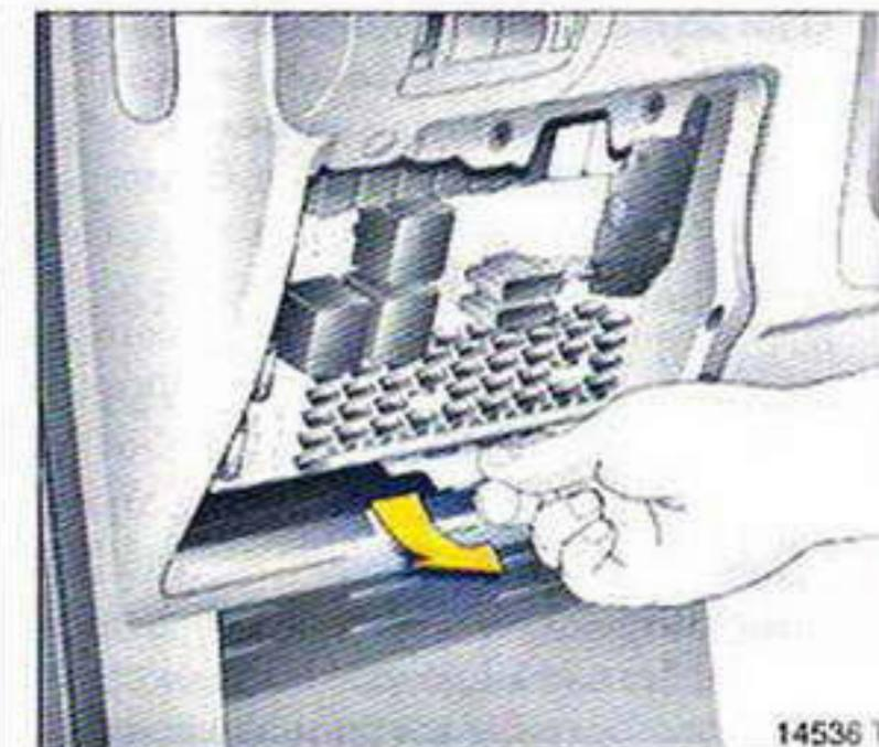
Для замены предохранителя освободить коробку предохранителей снизу посредством захвата и наклонить ее вперед.
