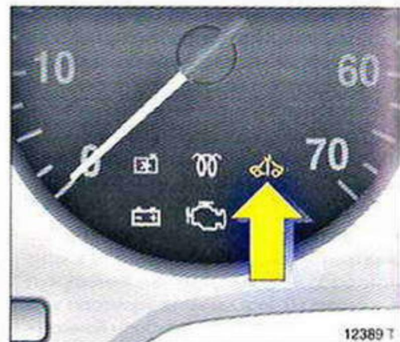
**Сигнализатор «» электронной системы двигателя**
