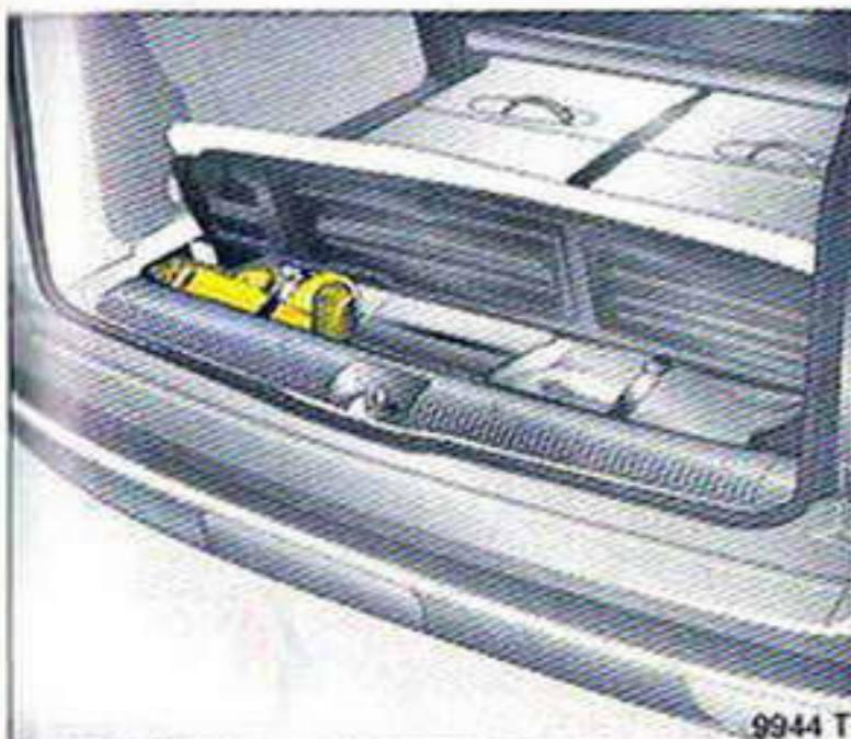
Чтобы открыть крышку, нужно поднять коврик, поднять, повернуть и вытянуть язычок фиксатора.
