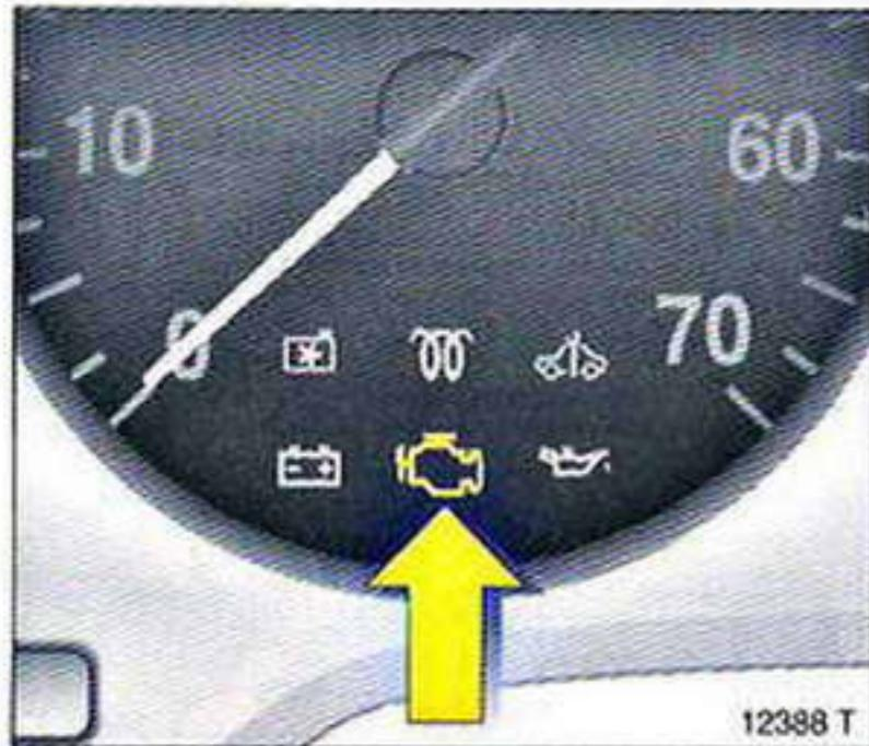
Мигание при работающем двигателе указывает на неисправность, которая может привести к повреждению катализатора. Можно продолжить движение без риска повреждения, если сбросить газ до такой степени, чтобы прекратилось мигание и сигнализатор горел непрерывно. Немедленно обратиться за помощью на станцию техобслуживания. Мы рекомендуем обращаться к партнеру фирмы Opel.
