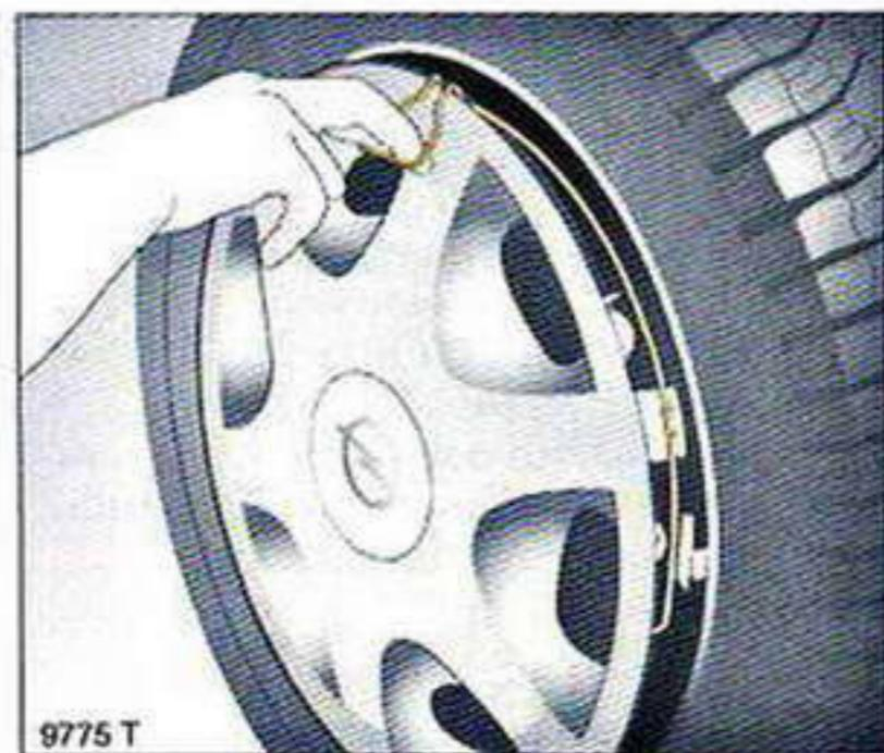
1. Снять колпак колеса \* с помощью крюка \* из набора инструментов автомобиля.
