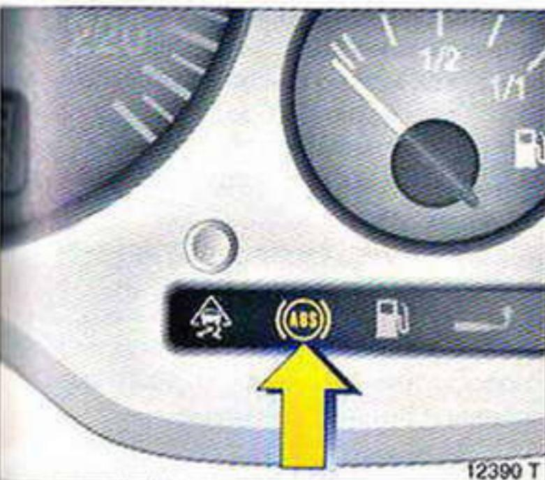
В случае неисправности системы ABS при чрезмерно резком торможении колеса могут заблокироваться. Преимущества системы ABS теряются. Автомобиль теряет управляемость и может сорваться в занос.
