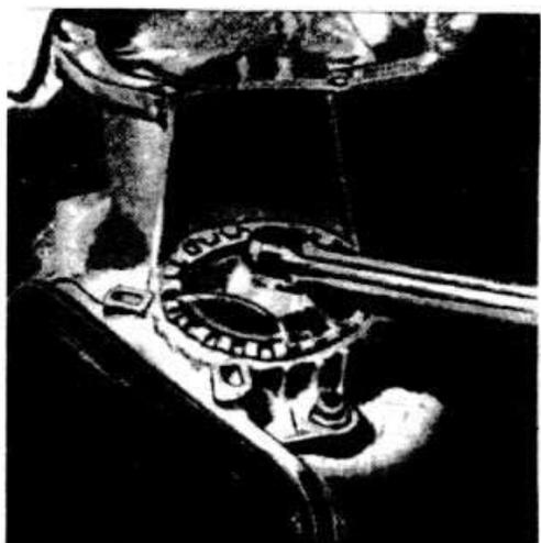
Снятие регулировочной гайки предварительного натяга подшипников коробки дифференциала
