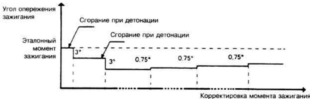
Принцип коррекции момента зажигания при детонации в одном цилиндре двигателя
