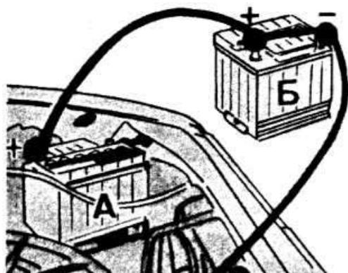
Схема подключения к разряженной аккумуляторной батарее А автомобиля внешней аккумуляторной батареи Б
