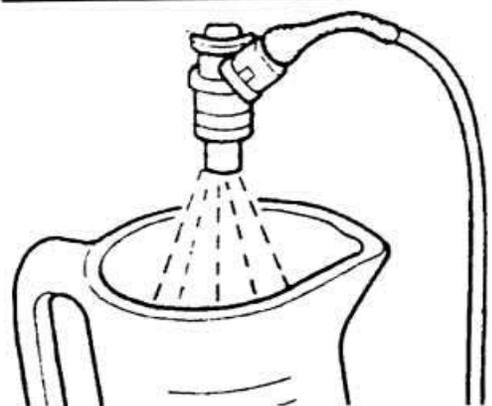
Проверка конуса распыла топлива форсункой
