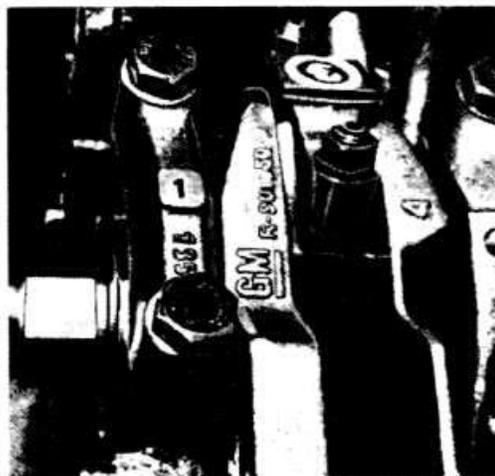
Проверка осевого зазора коленчатого вала
