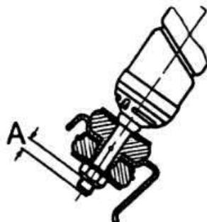
Размер «А» выступающего штока амортизатора на автомобилях с кузовом «универсал»
