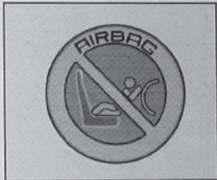
В автомобиле, оборудованном системой Airbag перевозка детей, на переднем сидении, в том числе в специальном креплении - не рекомендуется. Желательно перевозить их на заднем сидении. Об этом и о наличии системы Airbag для пассажира предупреждает наклейка с надписью "Airbag" на вещевом ящике и скобу на панели приборов, которые хорошо видны сразу при открывании двери.
