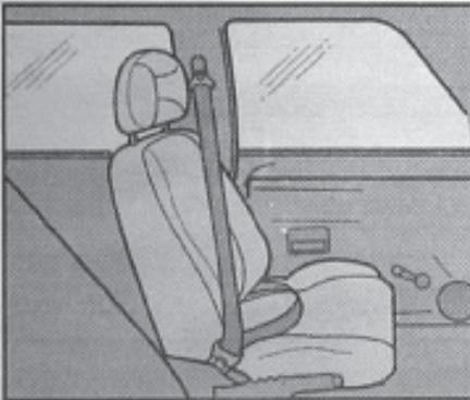
**Ремень безопасности плавно вытягивается из корпуса намоточного механизма, набрасывается на плечо и вставляется в замок**
