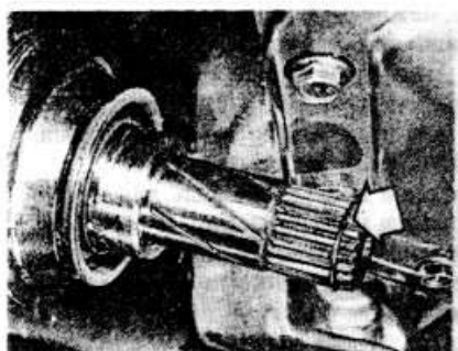
Рис. 8.7. Всегда надо менять пружинные стопорные кольца на ведущих валах
