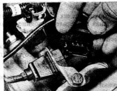
Рис. 2.48. Разъедините половины штепсельного разъема проводов — двигатель 1,6 л с многоточечным впрыском
