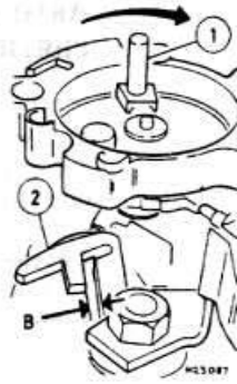
Рис. 4.31. Регулировка зазора воздушной заслонки 1. Рычаг заслонки 2. Регулировочный сегмент В Зазор
