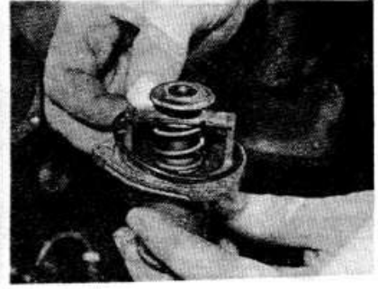
Рис. 3.5. ... и извлеките уплотнительное кольцо — 2,0 л с одним расширительным бачком
