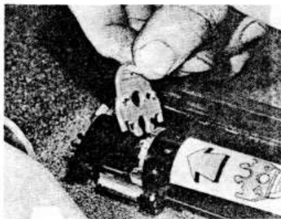
Рис. 11.37. Вставьте вилку безопасности в прорезь цилиндра натяжителя
