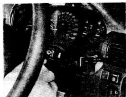
Рис. 12.21. Снятие нижнего винта крепления приборной панели
