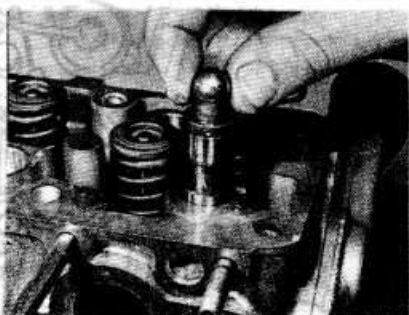
Рис. 2.58. Снимите гидравлические толкатели — двигатель 1,6 л
