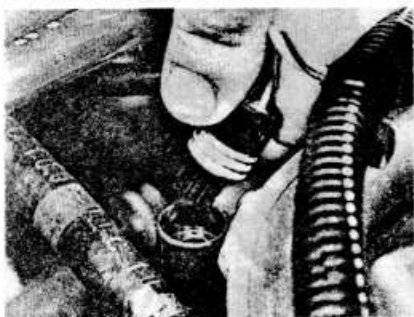
Рис. 4.64. Отсоедините штепсельный разъем датчика положения дроссельной заслонки — система одноточечного впрыска топлива
