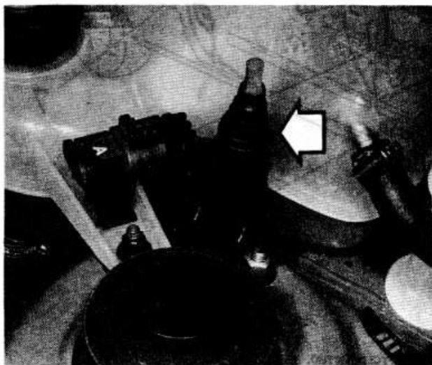
Рис. 12.39. Сигнализатор противоугонного устройства под капотом
