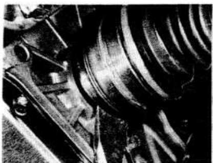
Рис. 8.4. Для извлечения ведущего вала из дифференциала пользуйтесь стальным прутком
