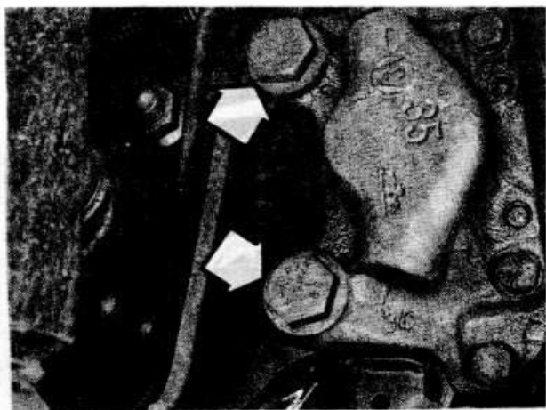
Рис. 9.20. Болты скобы тормоза заднего колеса (указаны стрелками)
