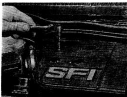
Рис. 4.95. Отворачивание болта воздушной коробки — система впрыска топлива Motronic M2.5
